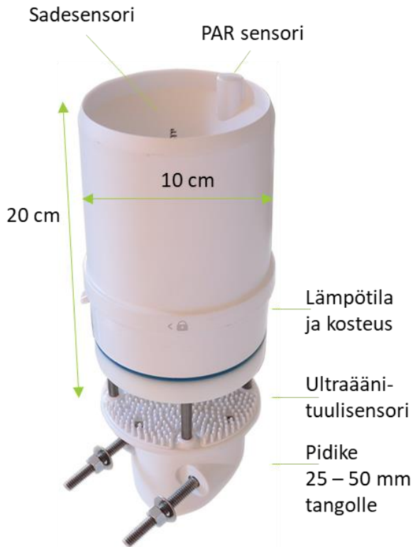
Kuva 6. Säälähettimen mitat ja sensoreiden sijainti
